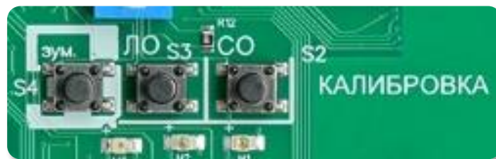
Рисунок 11. Кнопки СОЛОВЕЙ2-БУ1-хх «S2 КАЛИБРОВКА СО», «S3 КАЛИБРОВКА ЛО» и «S4 ЗУММ».
