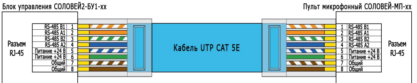
Рисунок 10. Схема подключения кабеля от СОЛОВЕЙ2-БУ1-хх к СОЛОВЕЙ-МП-хх.
