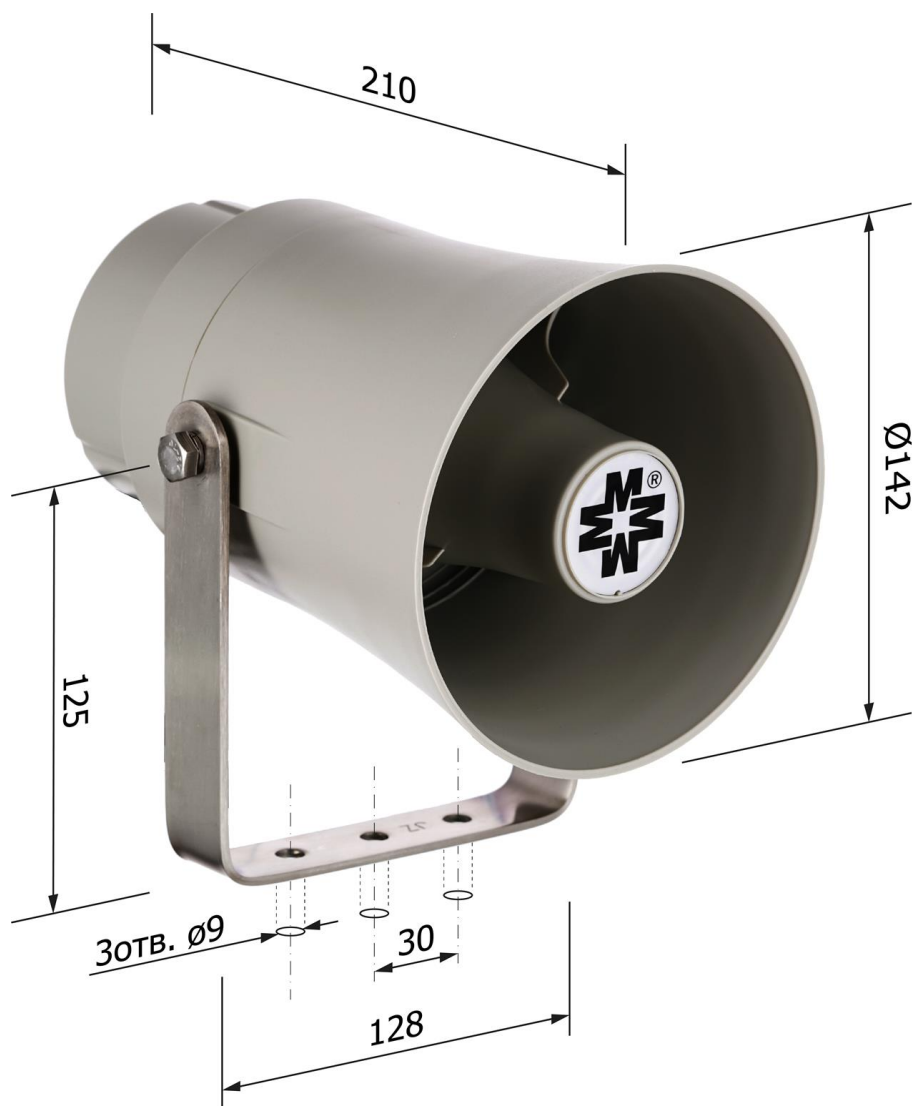
Рис.2 Габаритные и установочные размеры ГР.
