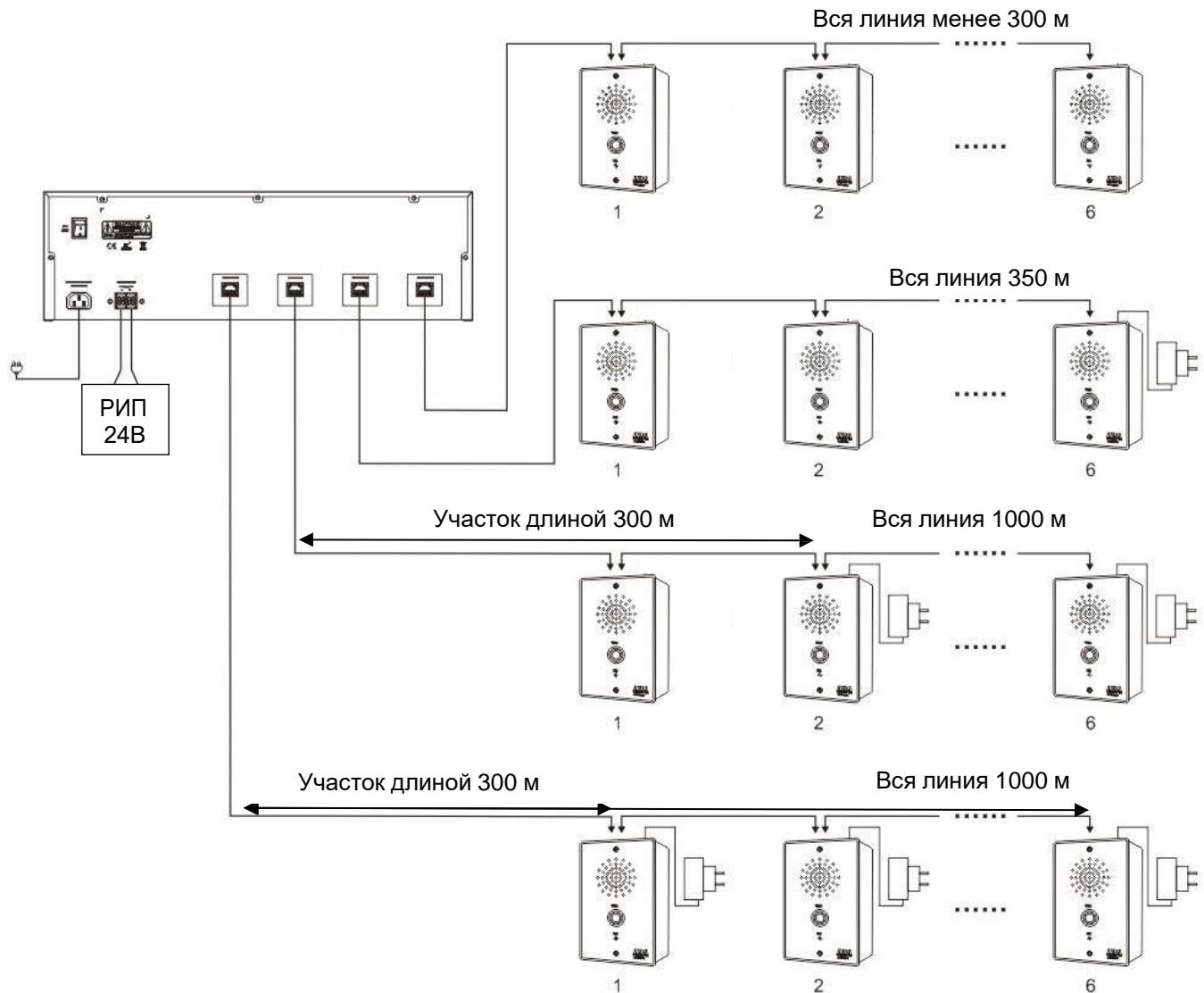
Для подключения вызывных панелей к блоку LPA-Duplex используется кабель UTP cat.5e 4x2x0,51
