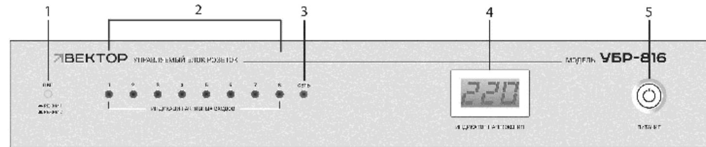
1. **«ПВП»** Функция поочередного включения розеток электропитания (Power sequencer)
