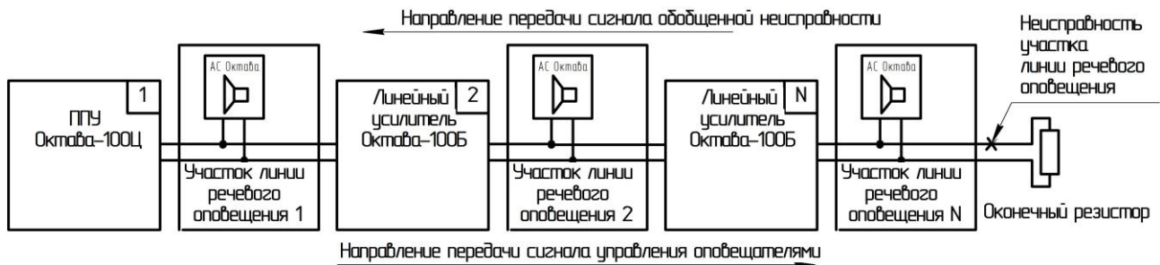
Рисунок 1.3 - Схема передачи сигнала «Неисправность» по линии речевого оповещения
