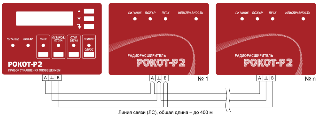
Рис.1 Подключение ПУО и РР к линии связи
