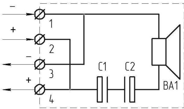
$R_{дин.} = 4 \Omega\text{м или } 8 \Omega\text{м (определяется при заказе)}$ .
