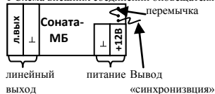
Рисунок – 1 Схема внешних соединений оповещателя «Соната-МБ»
