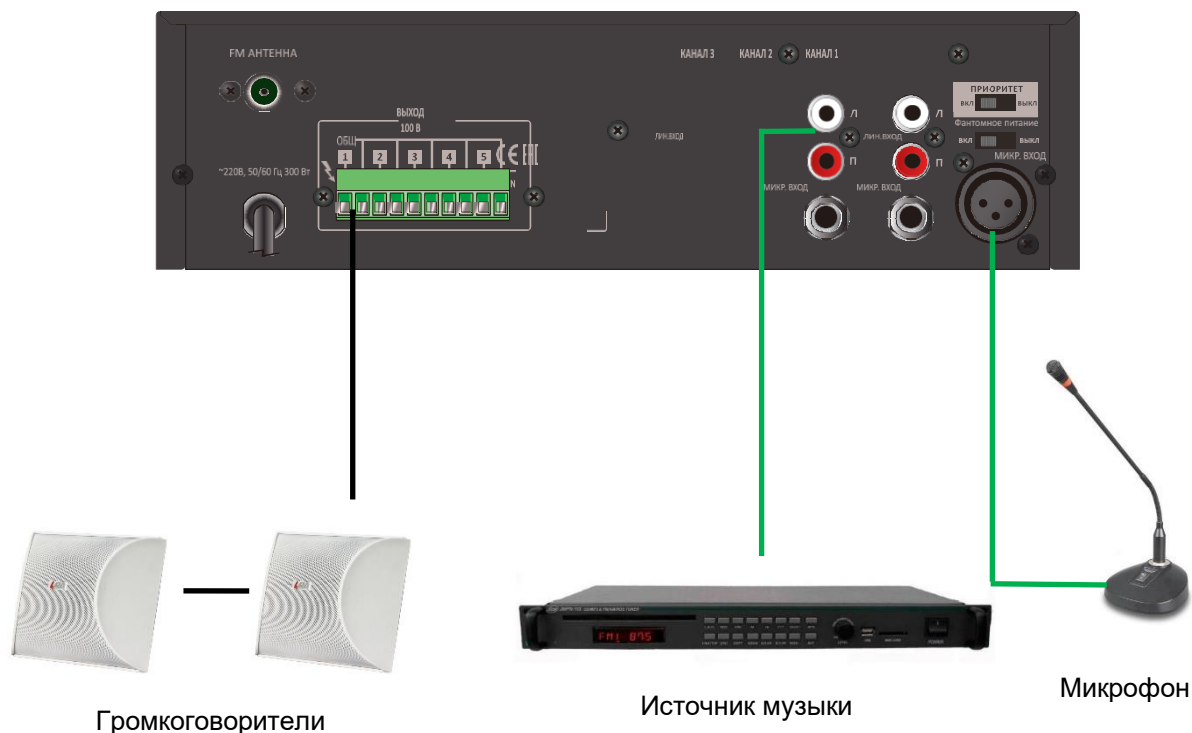
Рис. 2.1. Схема подключения LPA-TA-480MZ
